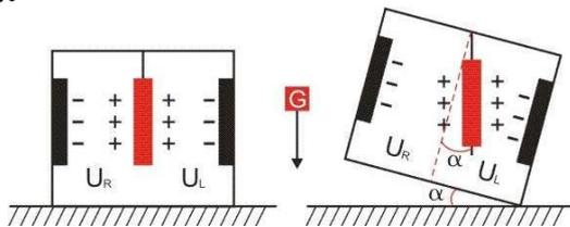
$U_R, U_L$  分别为摆锤的左极板和右极板与其各自对应电极间的电压，当倾角传感器倾斜时， $U_R, U_L$  会按照一定规律变化，所以  $f(U_R, U_L)$  是关于倾角  $\alpha$  的函数： $\alpha = f(U_R, U_L)$
