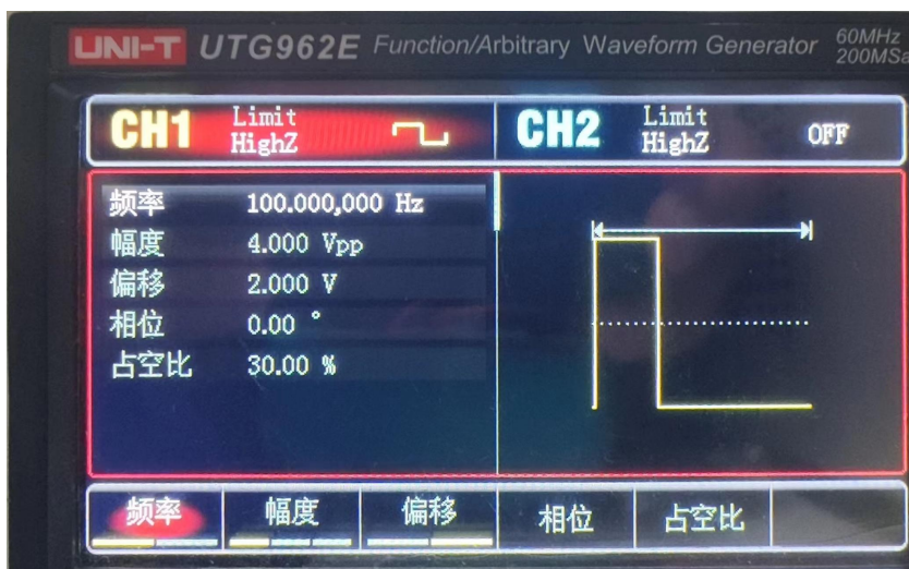
图 4.4.1.1 波形发生器产生的方波
