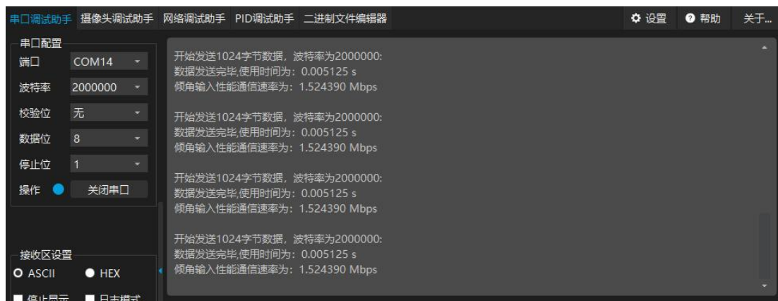
图 4.7.1.1 采集器和倾角传感器通信速率
