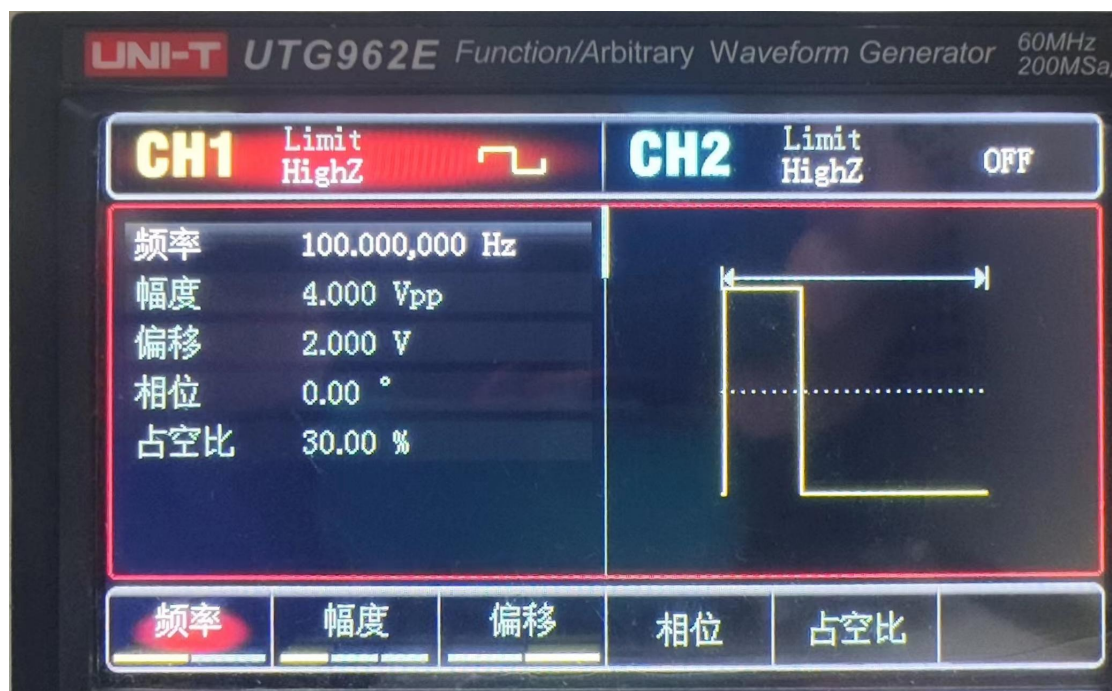
图 4.3.1.1 波形发生器产生的方波
