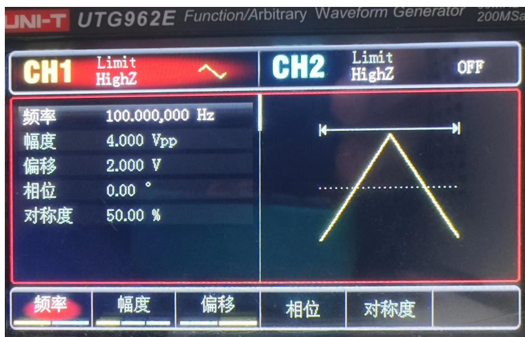
图 4.4.3.1 波形发生器产生的三角波
