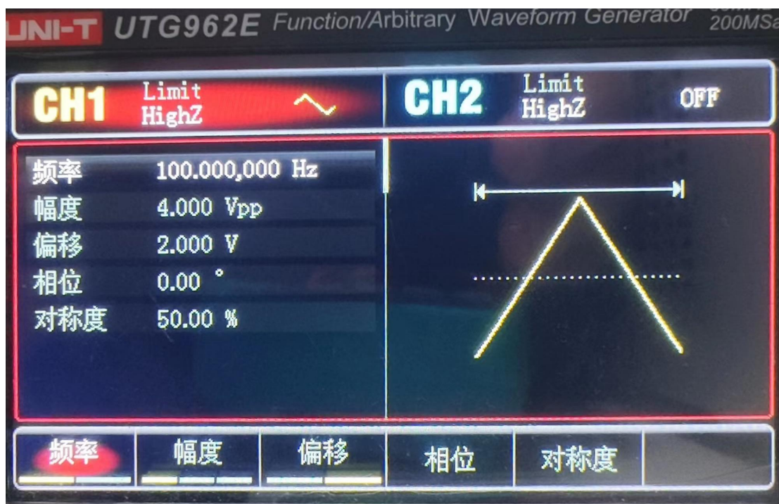
图 3.3.3.1 波形发生器产生的三角波
