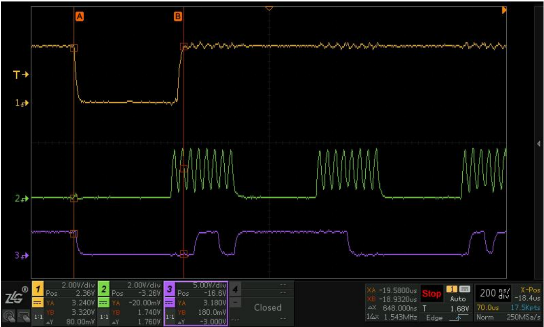
图 1.2 DRDY 信号低电平时间 648ns
